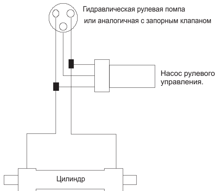
Рисунок 3.14 Подключение к типовой двухлинейной системе.
